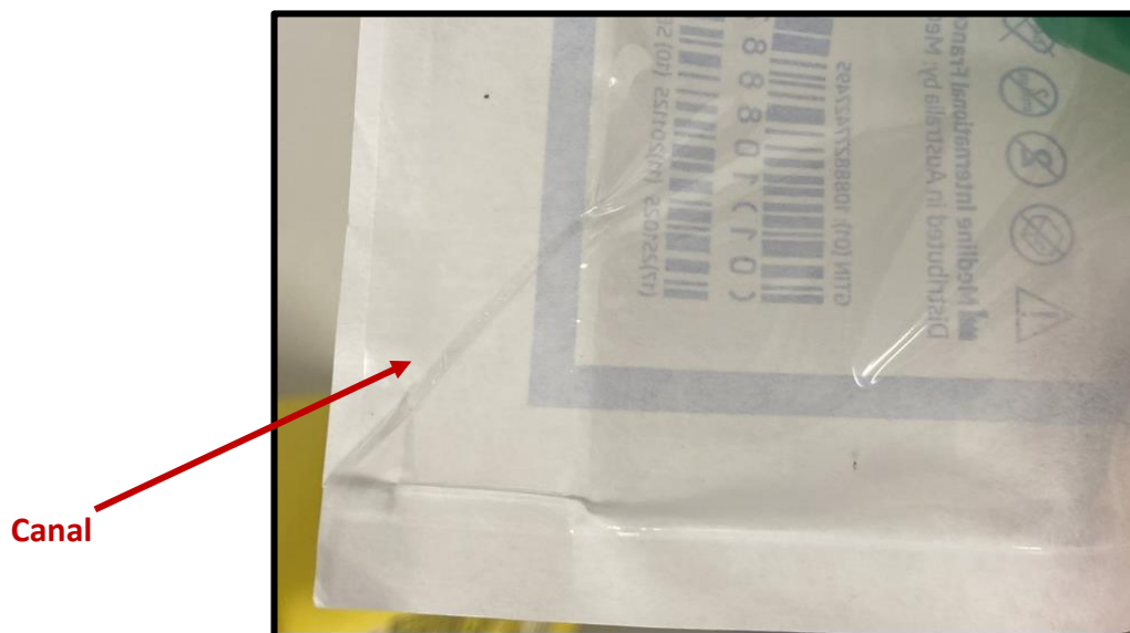
Image 1 : Exemple d'un scellage défectueux avec un « canal »
